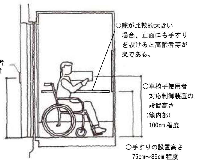
○図 6.4 手すりや制御装置の高さ
